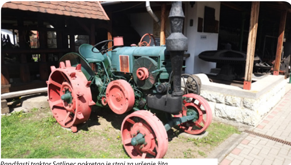
Pandžasti traktor Satlinec pokretao je stroj za vršenje žita
